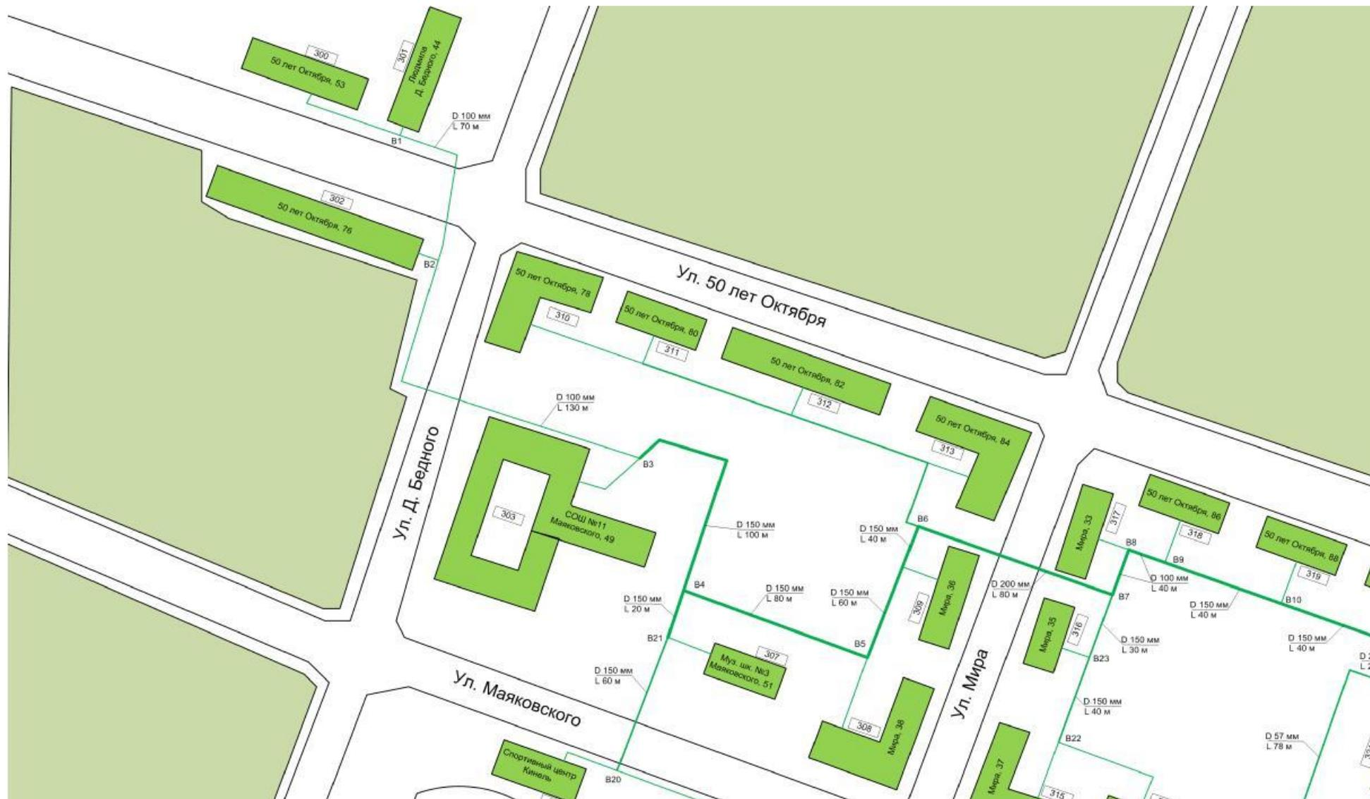
Рисунок 1.3.2.4 - Схема тепловых сетей котельной №3 г. Кинель
