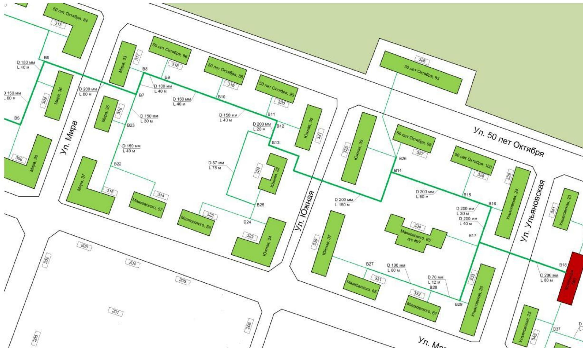
Рисунок 1.3.2.6 - Схема тепловых сетей котельной №3 г. Кинель
