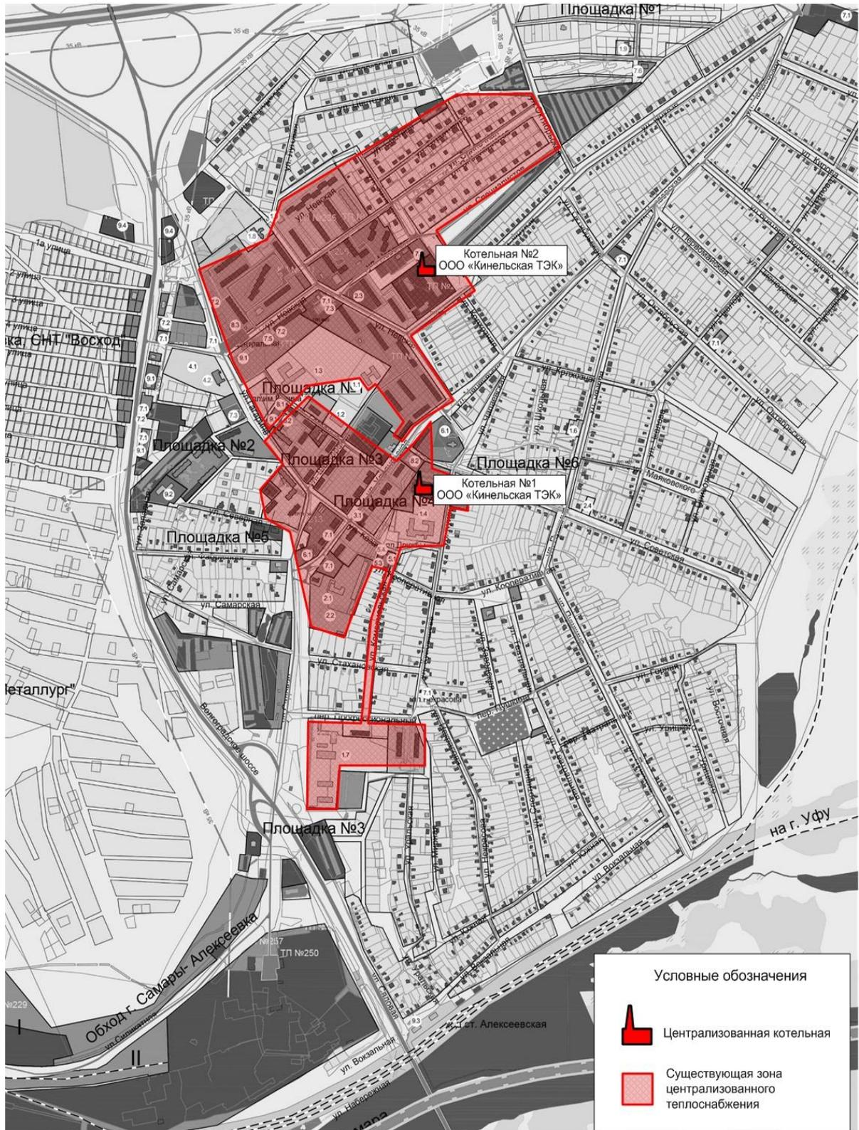
Рисунок 1.4.3 – Зоны действия существующей системы централизованного теплоснабжения п.г.т. Усть-Кинельский
